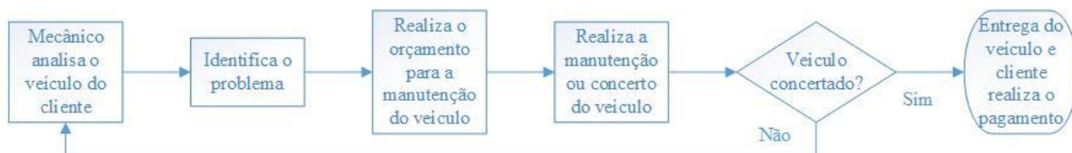
Figura 5 – Descrição do processo produtivo da oficina mecânica para a função de mecânico Fonte: Os autores, a partir da pesquisa de campo
